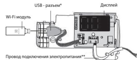
\* Разъем для подключения Wi-Fi модуля
