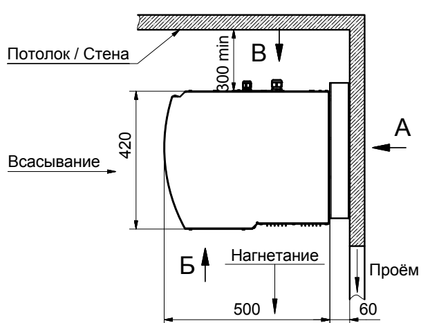
Рисунок 6. Габаритные и присоединительные размеры
