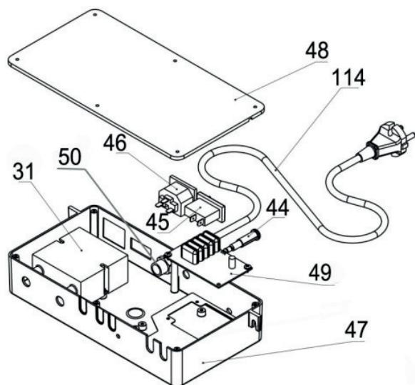
Таблица А1 – Перечень деталей к внешнему виду дизельного теплогенератора NPD-15
