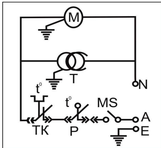
Приложение А. Схема соединений компрессора, мотора и вентилятора
